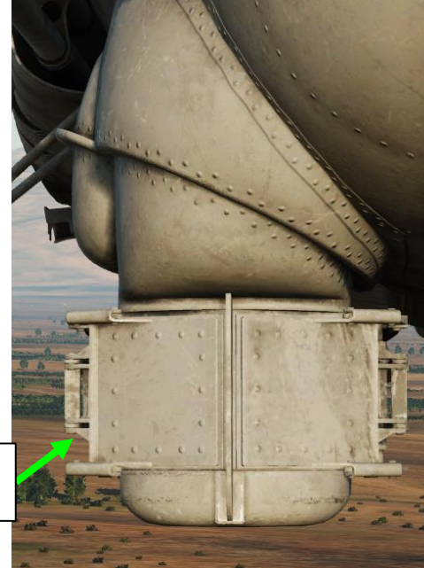
Periskop vnější dveře se otevírají vnitřní dveře v pohybu
