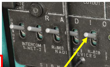
R-828 LVHF Rádio (M24 "Eucalyptus") vypínač napájení • NAHORU: ZAP/DOLŮ: VYP
