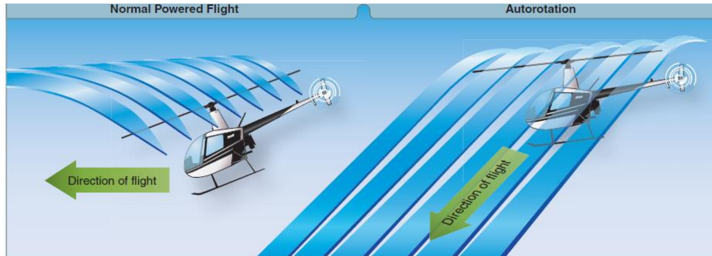
Obrázek 11-1. Během autorotace umožňuje vzestupné proudění relativního větru, aby se listy hlavního rotoru otáčely normální rychlostí. Lopatky v podstatě "kloužou" ve své rotační rovině.
