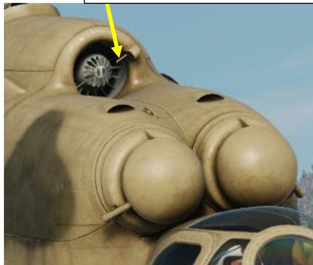
Radioizotopový detektor ledu
